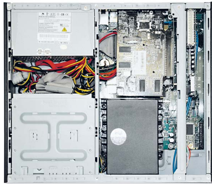
Der BTX-Gehäusestandard erlaubt die bessere Kühlung der Komponenten
