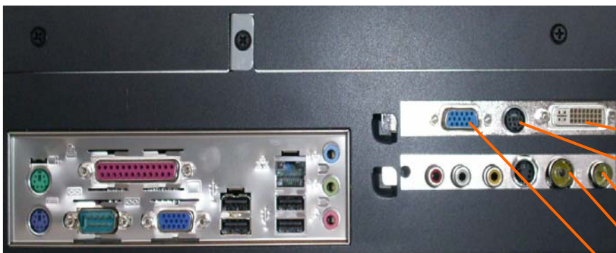
Abbildung: Analog TV-Karte und Grafikkarte auf der Rückseite des XP2C SilverStone Media Center PCs.
