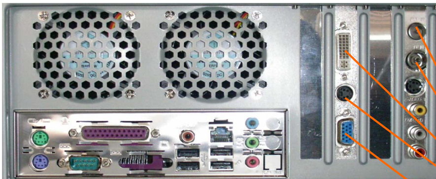
Abbildung: Analog TV-Karte und Grafikkarte auf der Rückseite des XP2C LC10 Windows Media Center PCs.
